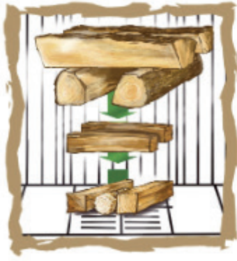
Stapeln Sie das Feuerholz Entsprechend dieser Beschreibung
